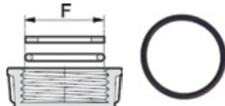
Juntas Tóricas para Tapones Hembra Gasket for Blanking Caps Joint pour Bouchons d'obturation
