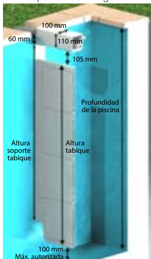
Soportes para fijar sobre los soportes de la vigueta
