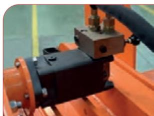
Motor hidráulico regulable del rodillo alimentador.
