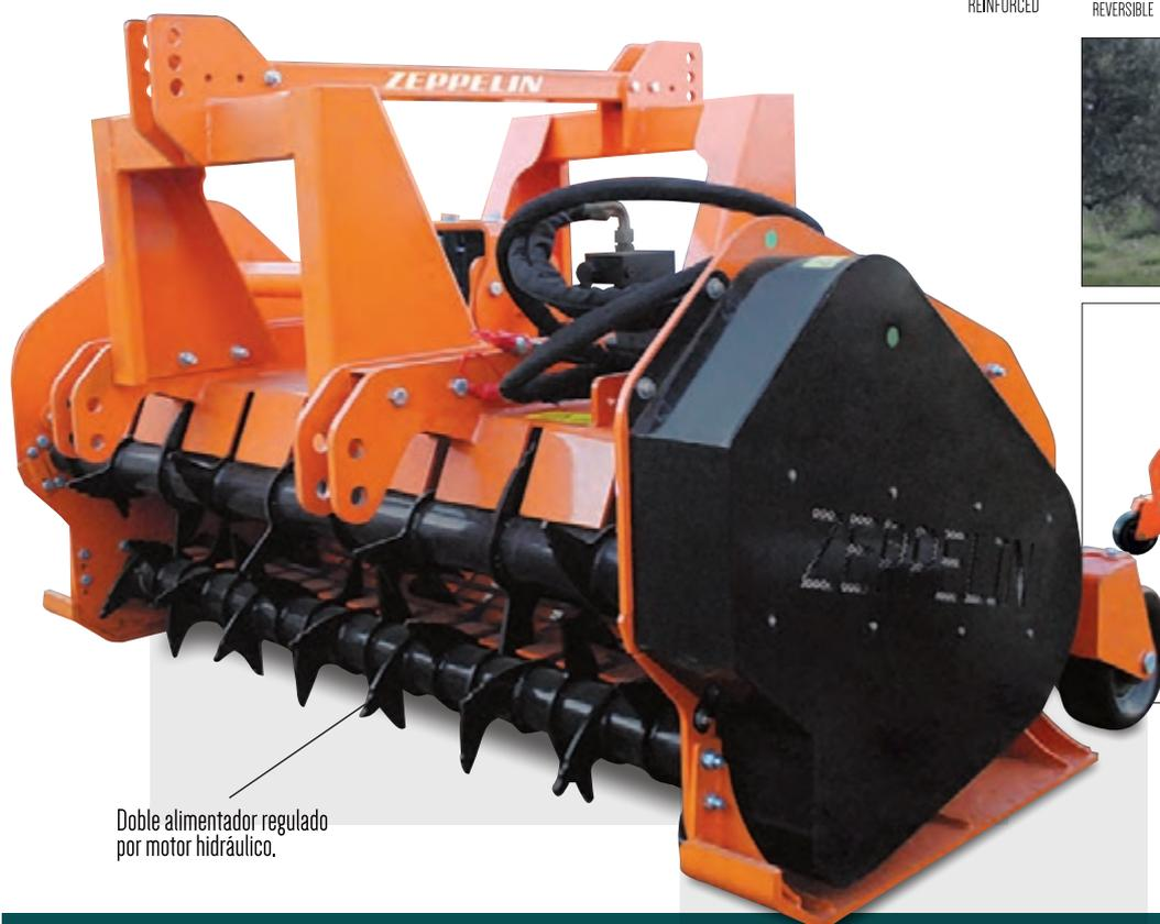
Doble alimentador regulado por motor hidráulico.
